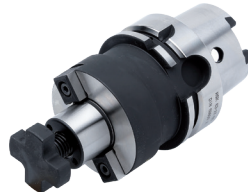
Quernut-Aufsteckfräserdorne DIN 6357 mit vergrößerter Anlagefläche und Kühlkanalboh- rungen an der Stirnseite Shell mill holders DIN 6357 with enlarged contact face and coolant exit bores on the end face Porte-fraises à trou lisse DIN 6357 avec face de contact élargie et conduits pour l'arrosage frontal
